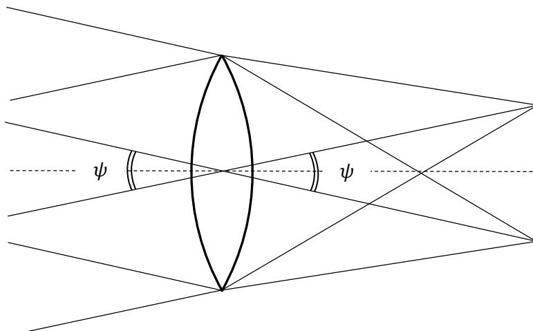
угловому расстоянию между их изображениями на матрице. И если расстояние между этими изображениями превысит размеры пикселя, то они попадут на разные пиксели и не сольются в одно целое. Следовательно, минимально различимый угол будет связан с размерами пикселя и фокусным расстоянием следующим образом:  $\psi = d_{pix}/F \cdot 206\ 265'' = 140''$ . Это значение гораздо больше дифракционной разрешающей способности ( $41''$ ), и оно будет главным ограничивающим фактором.
